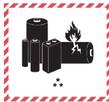
Gambar rajah 1: Pelabelan bateri litium
