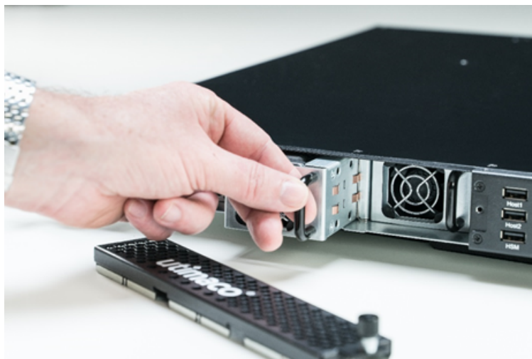
Figure 68 : Pulling out the fan module
