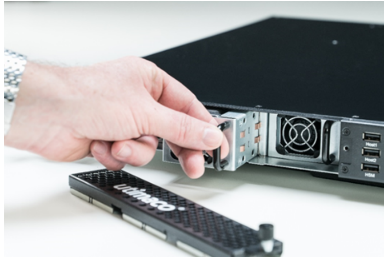
Figure 68 : Pulling out the fan module
