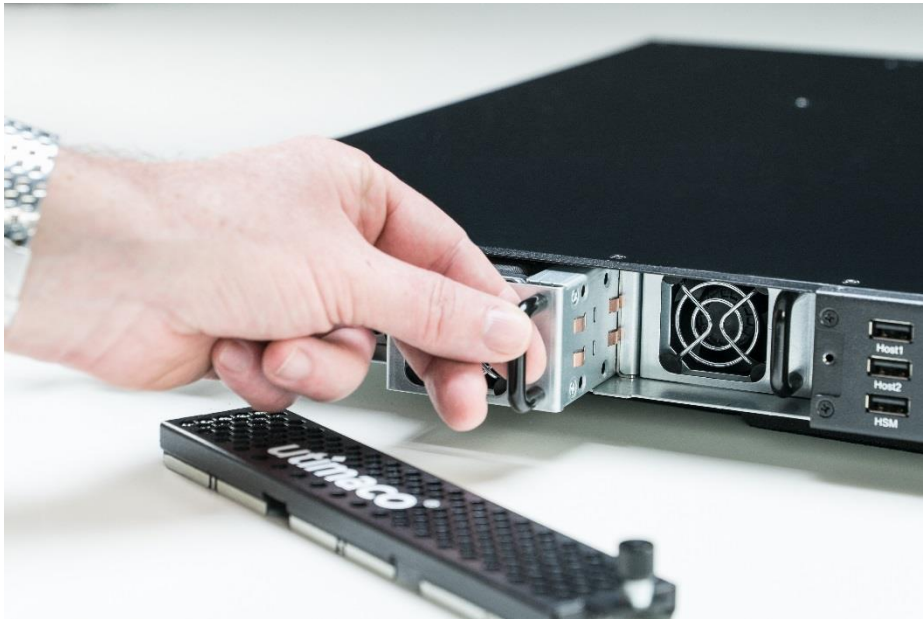
Figure 50: Pulling out the fan module
