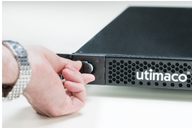
Figure 36 : Batteriefach der u.trust Anchor LAN V5 öffnen
