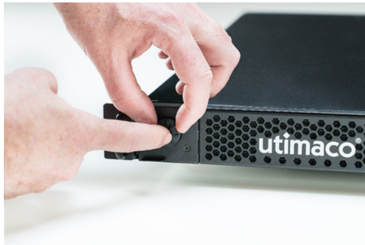
Figure 40 : Schraubdeckel des Batteriefachs für festschrauben
