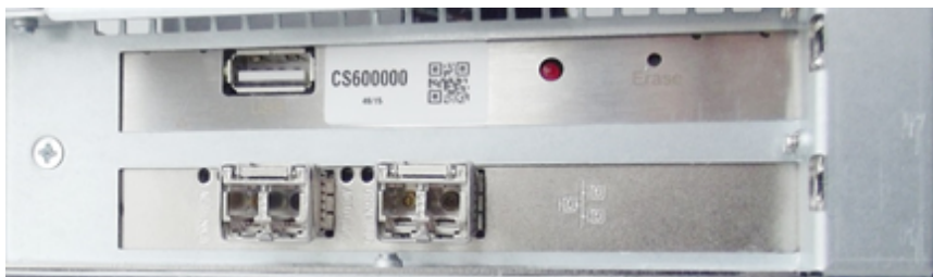
Figure 24 : PCIe-Netzwerkkarte mit Glasfaseranschluss ohne Blindstopfen
