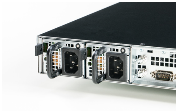
Figure 41 : Netzteilmodule auf der Rückseite der u.trust Anchor LAN V5
