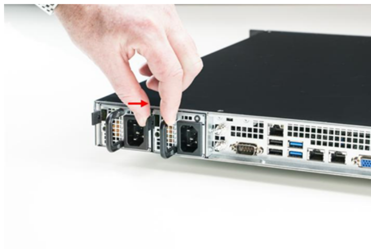
Figure 42 : Verriegelung des Netzteilmoduls drücken
