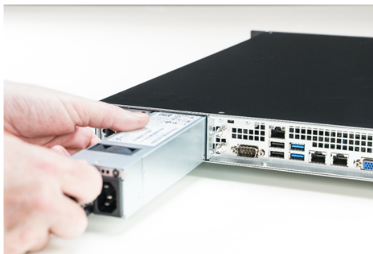
Figure 44 : Das Netzteilmodul herausziehen
