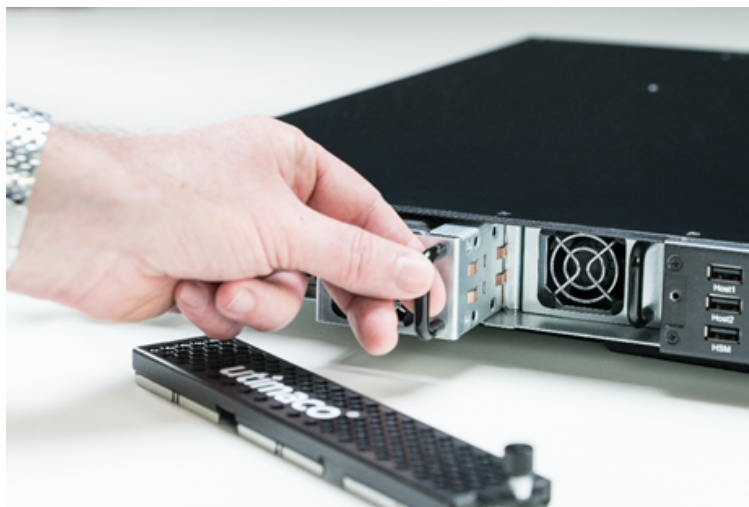
Figure 49 : Lüftermodul herausziehen
