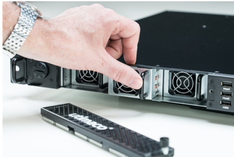
Figure 50 : Lüftermodul einsetzen
