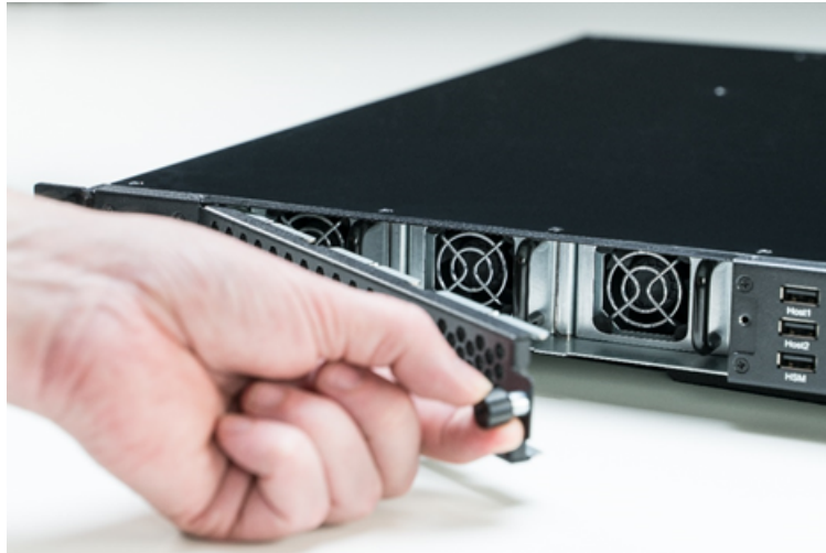
Figure 48 : Lüfterfach öffnen
