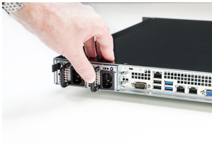
Figure 46 : Bügel des Netzteilmoduls benutzen
