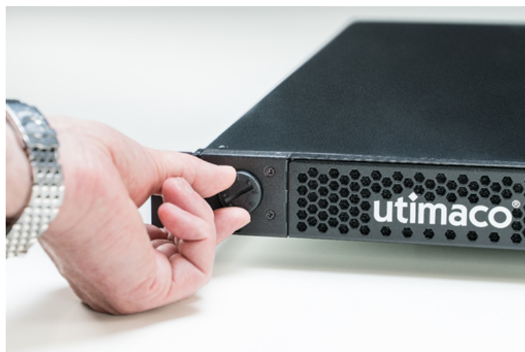
Figure 35 : Schraubdeckel des Batteriefachs der u.trust Anchor LAN V5 drehen
