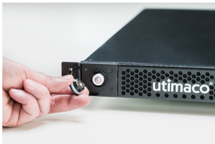
Figure 37 : Schraubdeckel des Batteriefachs entfernen
