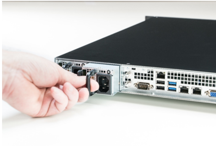
Figure 43 : Bügel des Netzteilmoduls benutzen
