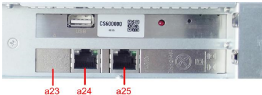
Figure 27 : PCIe-Netzwerkkarte mit Kupferkabelanschluss auf der Rückseite eines u.trust Anchor LAN V5
