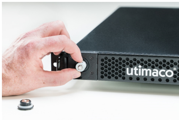
Figure 39 : Batterie der u.trust Anchor LAN V5 ins Batteriefach einlegen
