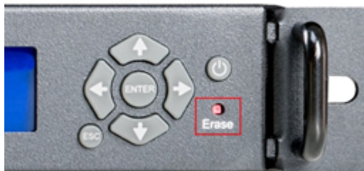
Figure 52 : ERASE-Taster zur Durchführung eines External Erase auf dem u.trust Anchor LAN V5
