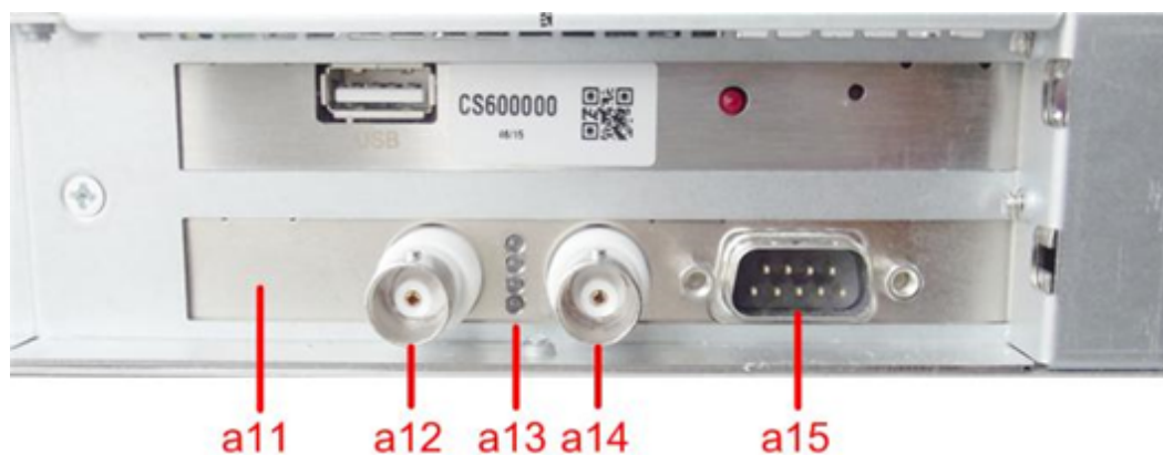
Figure 22 : PCIe-Uhrkarte auf der Rückseite einer u.trust Anchor LAN V5
