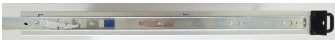
Figure 61 : An der u.trust Anchor LAN befestigte innere Gleitschiene
