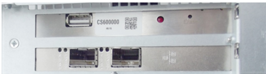
Figure 25 : PCIe-Netzwerkkarte mit Glasfaseranschluss ohne Transceiver-Module
