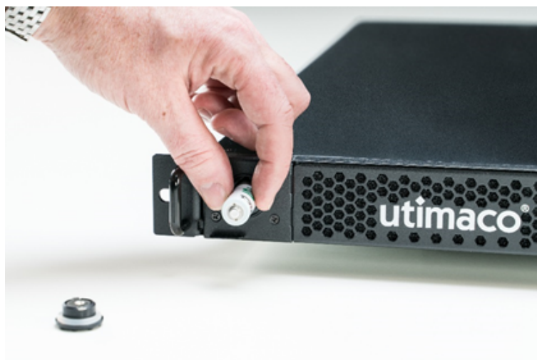
Figure 38 : Batterie der u.trust Anchor LAN V5 herausnehmen
