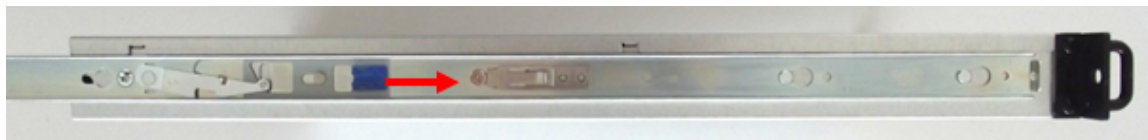
Figure 16 : Verschieben des Sperrriegels auf der linken Seite der u.trust Anchor LAN V5
