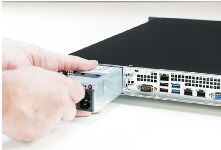
Figure 45 : Netzteilmodul einsetzen
