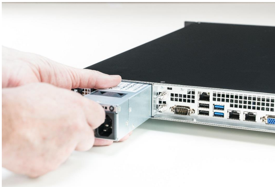
Abbildung 46: Netzteilmodul einsetzen
