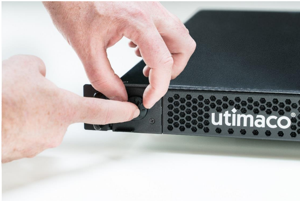
Abbildung 41: Schraubdeckel des Batteriefachs für die Batterie festschrauben
