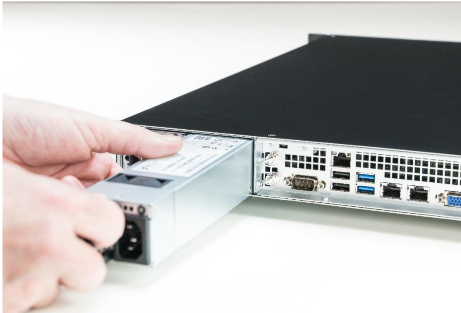
Abbildung 45: Das Netzteilmodul herausziehen
