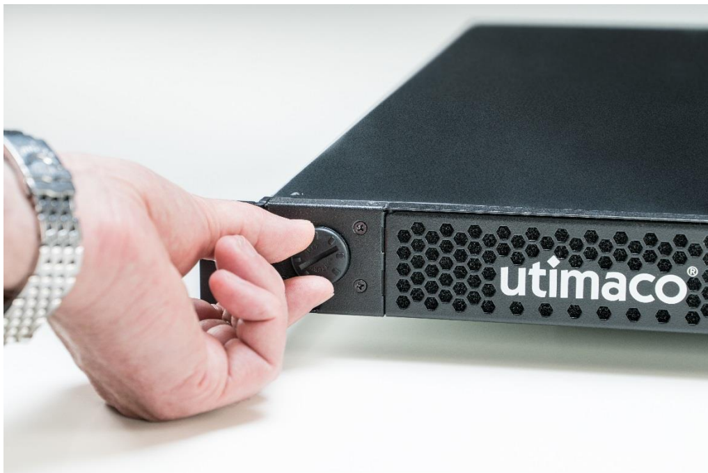
Abbildung 36: Schraubdeckel des Batteriefachs des CryptoServer LAN V5 drehen
