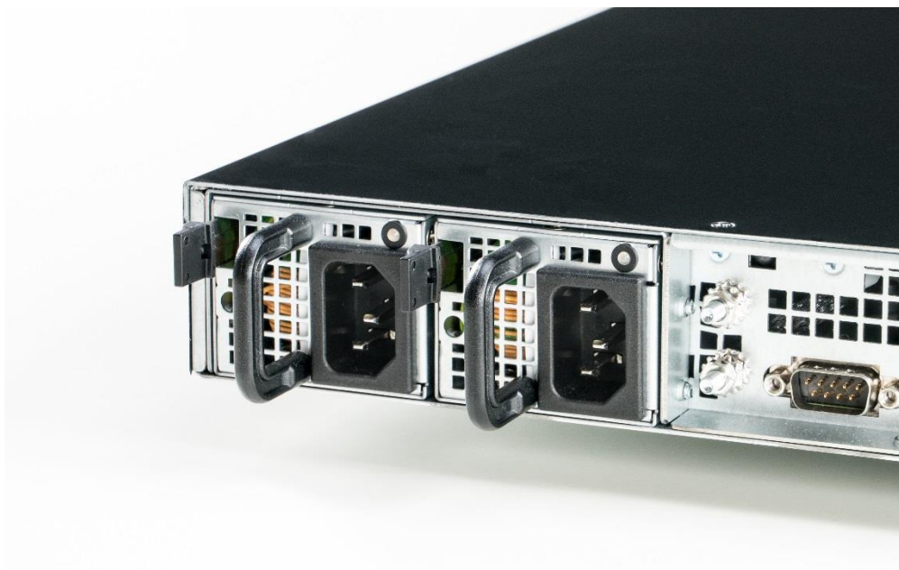
Abbildung 42: Netzteilmodule auf der Rückseite des CryptoServer LAN V5
