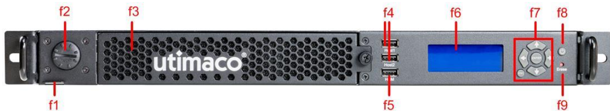
Abbildung 31: CryptoServer LAN V5 - Anschlüsse und Bedienelemente auf der Vorderseite
