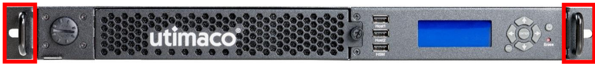
Abbildung 18: Befestigungswinkel des CryptoServer LAN V5
