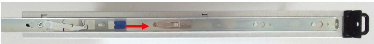
Abbildung 16: Verschieben des Sperrriegels auf der linken Seite des CryptoServer LAN V5
