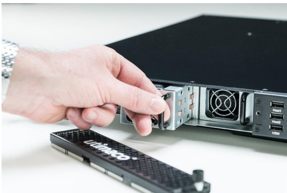
Abbildung 50: Lüftermodul herausziehen
