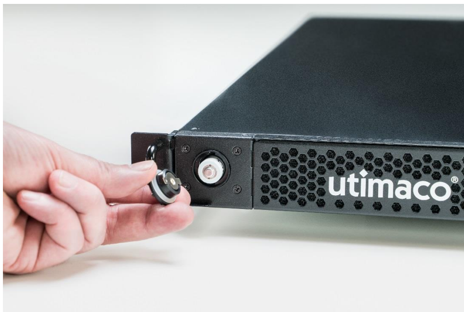
Abbildung 38: Schraubdeckel des Batteriefachs entfernen
