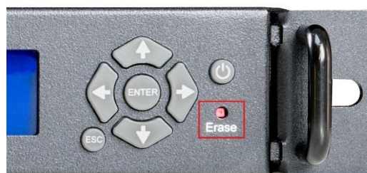
Abbildung 53: ERASE-Taster zur Durchführung eines External Erase auf dem CryptoServer LAN V5
