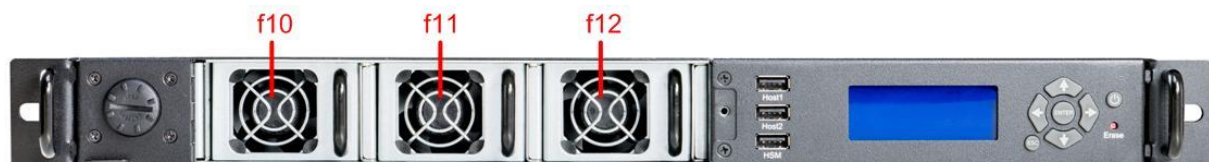
Abbildung 32: CryptoServer LAN V5 – Vorderseite mit entfernter Abdeckung des Lüfterfachs
