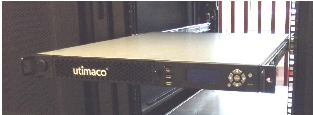
Abbildung 15: CryptoServer LAN V5 in der Sperrposition
