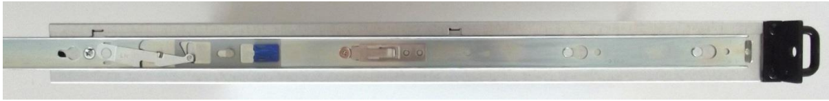
Abbildung 14: Auf dem CryptoServer LAN V5 befestigte innere Gleitschiene
