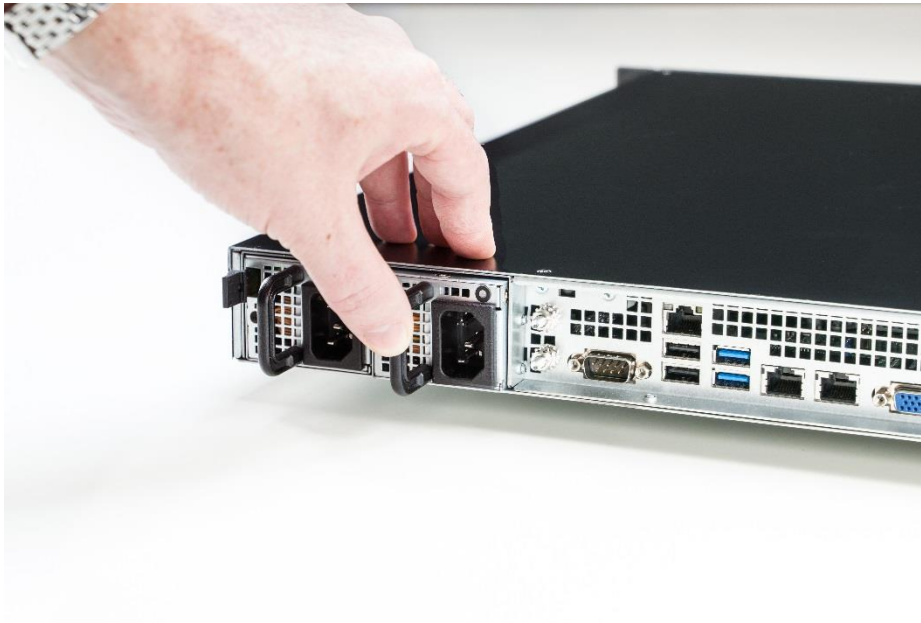
Abbildung 47: Bügel des Netzteilmoduls benutzen
