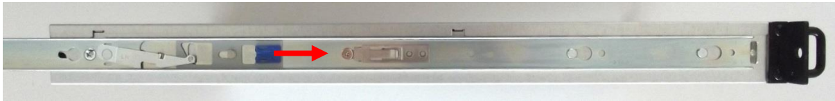
Abbildung 58: Entriegeln des Sperrriegels auf der linken Seite des CryptoServer LAN V5
