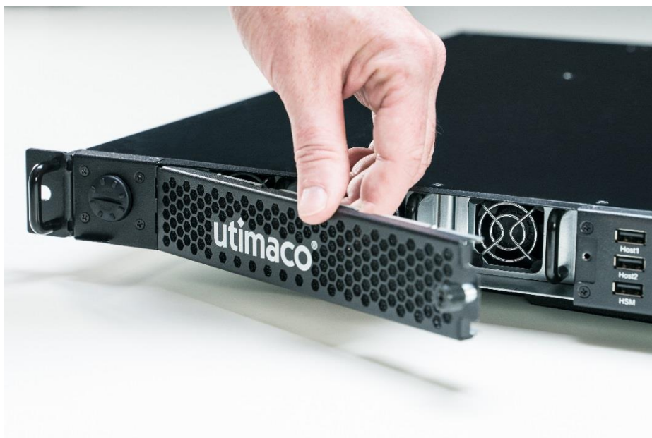
Abbildung 52: Abdeckung einsetzen
