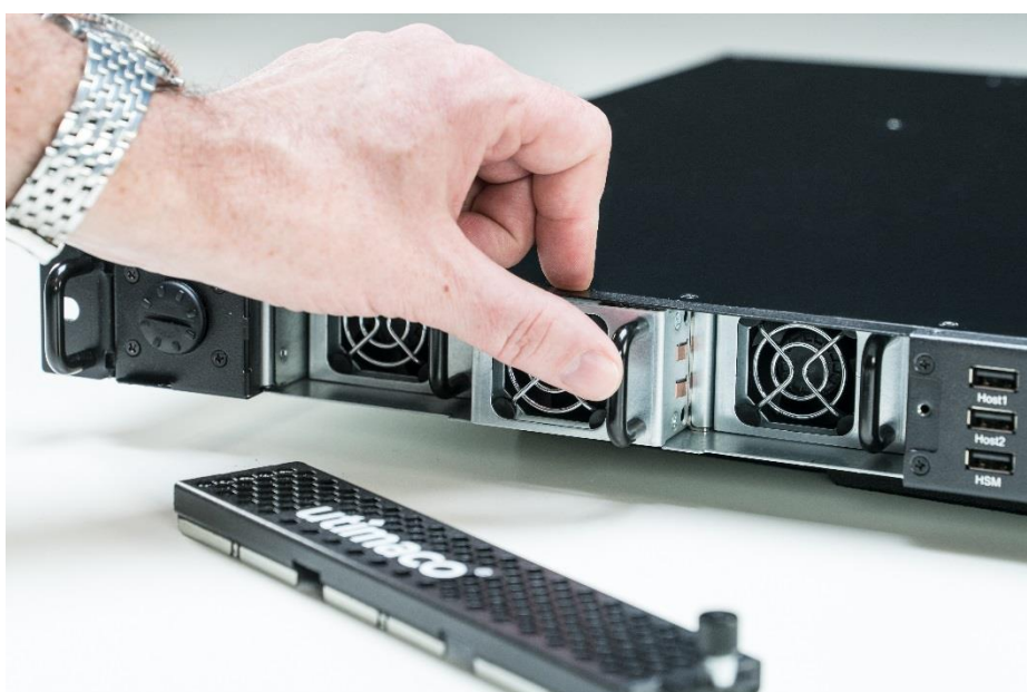
Abbildung 51: Lüftermodul einsetzen
