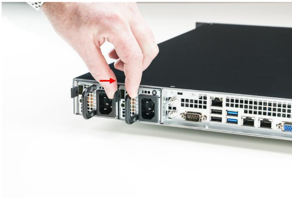
Abbildung 43: Verriegelung des Netzteilmoduls drücken
