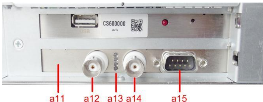
Abbildung 24: PCIe-Uhrkarte auf der Rückseite eines CryptoServer LAN V5
