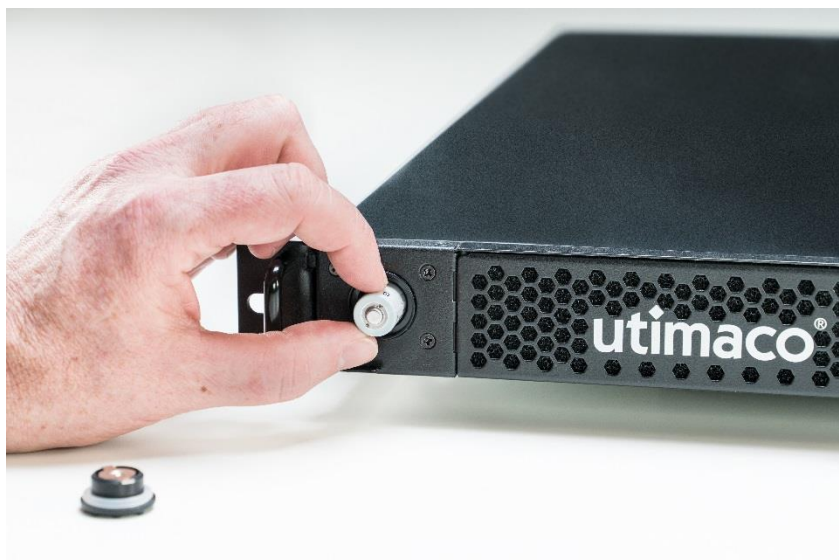
Abbildung 40: Batterie des CryptoServer LAN V5 herausnehmen
