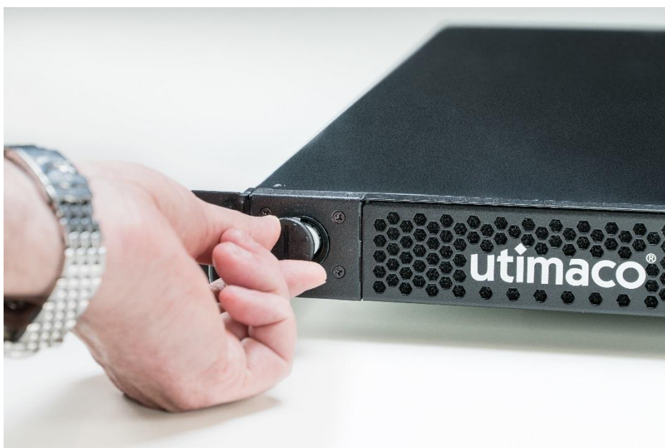
Abbildung 37: Batteriefach des CryptoServer LAN V5 öffnen
