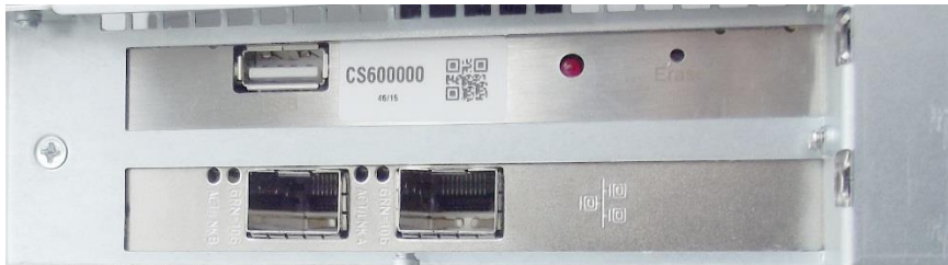
Abbildung 27: PCIe-Netzwerkkarte mit Glasfaseranschluss ohne SFP-Transceiver-Module
