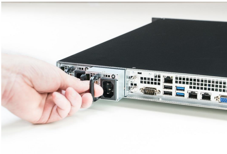
Abbildung 44: Bügel des Netzteilmoduls benutzen
