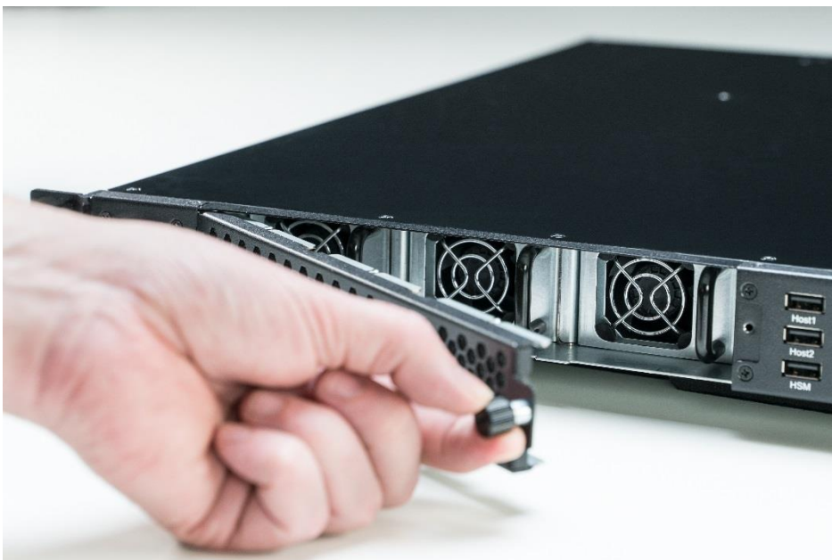
Abbildung 49: Lüfterfach öffnen
