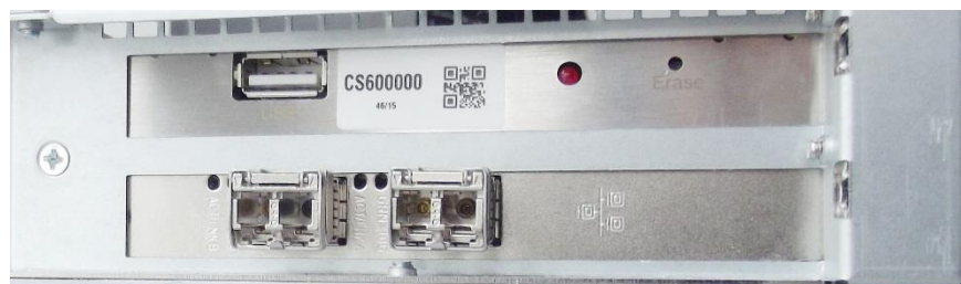
Abbildung 26: PCIe-Netzwerkkarte mit Glasfaseranschluss ohne Blindstopfen
