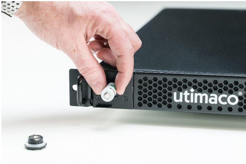
Abbildung 39: Batterie des CryptoServer LAN V5 herausnehmen
