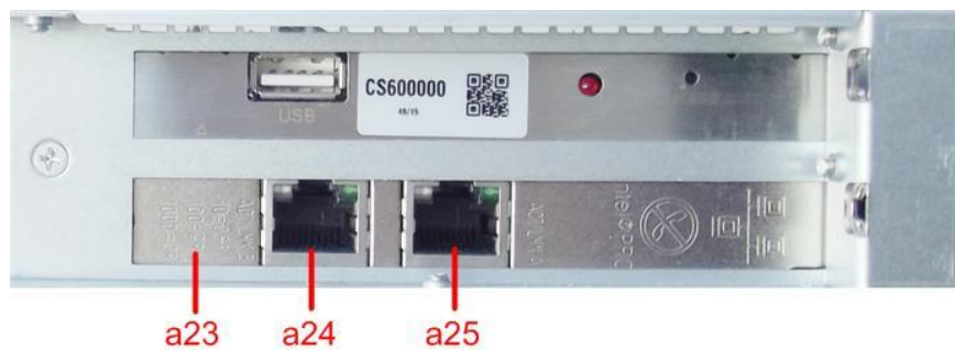
Abbildung 29: PCIe-Netzwerkkarte mit Kupferkabelanschluss auf der Rückseite eines CryptoServer LAN V5
